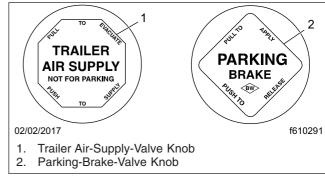
Fig. 13.2, Brake Valve Knobs
