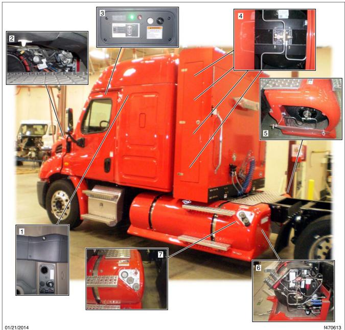
1. Sleeper Leak Sensor (zone 3)
